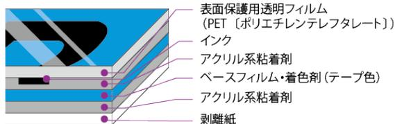
ラミネートフィルムが印刷面を保護する独自の構造により擦れ、汚れ、薬品、溶剤などに対して優れた耐久性を発揮します。耐久性が求められる用途に幅広くお使いいただけます。
